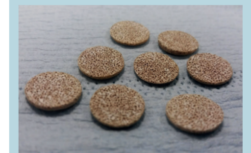
Implant osseux hybride à base de bioverre et polycaprolactone utilisé pour le comblement dentaire et breveté par le LPC.
