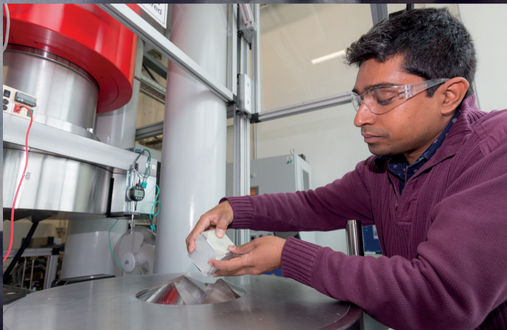
Geeth MANTHILAKE installant un assemblage expérimental dans la presse multi-enclumes 1500 T, Instrument National INSU-CNRS. Crédit photo : LMV
